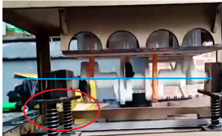
Figura 21: Funcionamiento del cigüeñal con contrapesos
